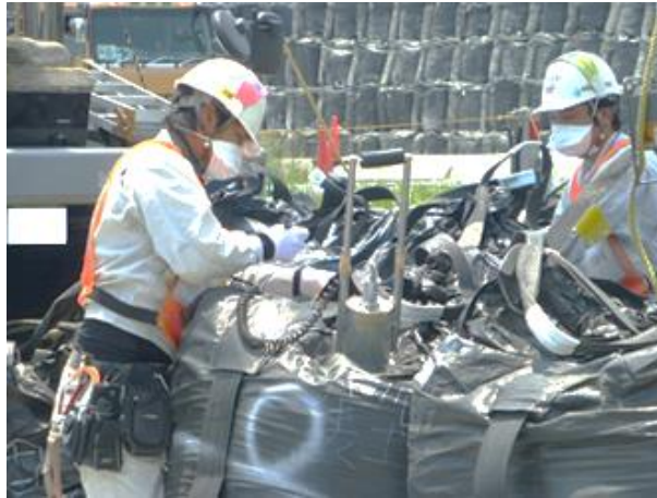
図 2.1.3-8 容器の表面線量率の測定状況
