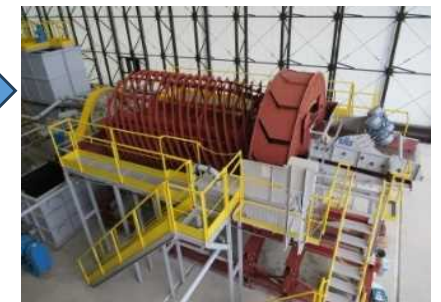
沈降分離により、砂と粘土・シルトを分別し、主に「砂」を回収する設備
